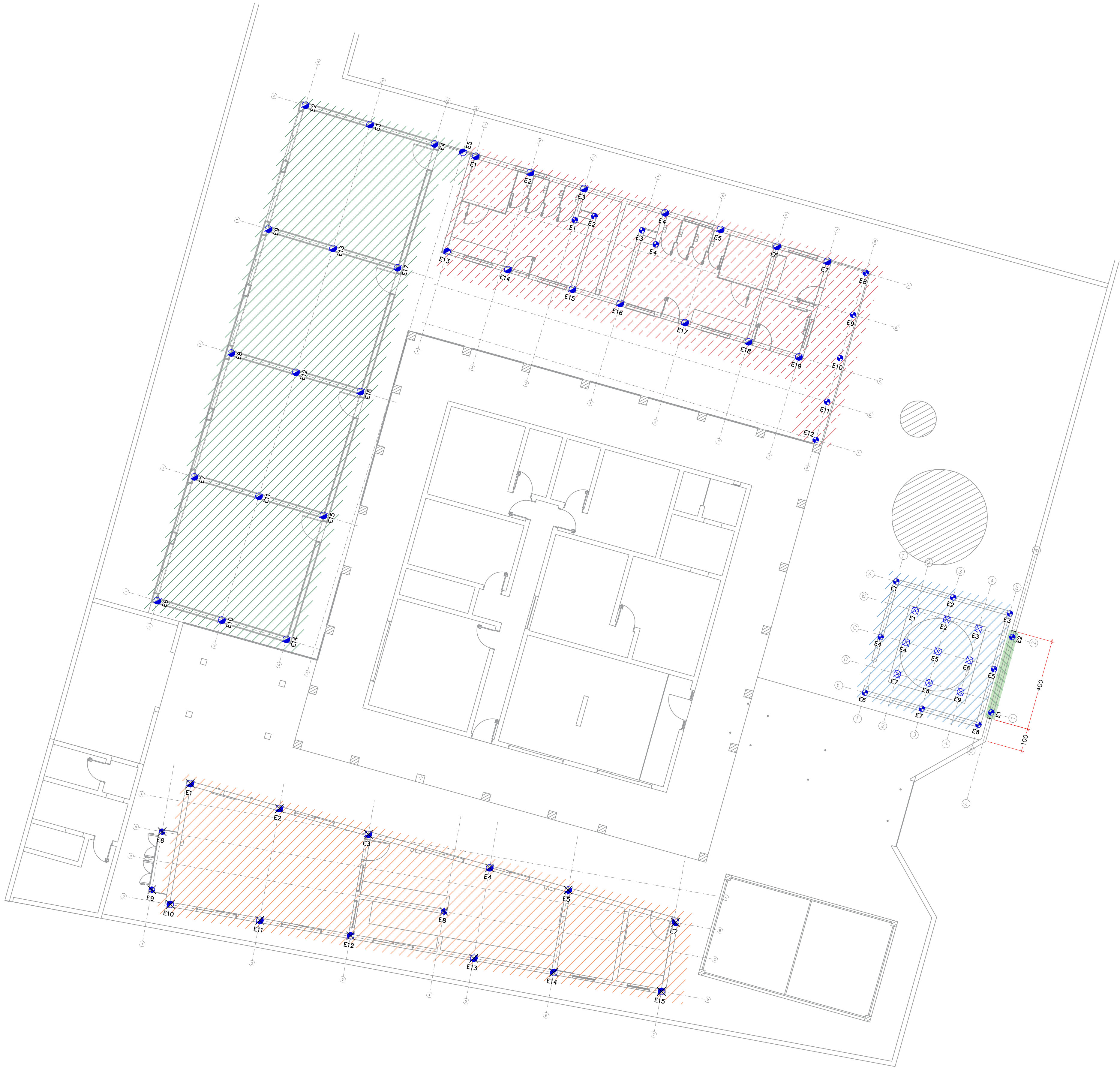
PLANTA GERAL DE LOCAÇÃO DAS ESTACAS ESCALA 1:100
