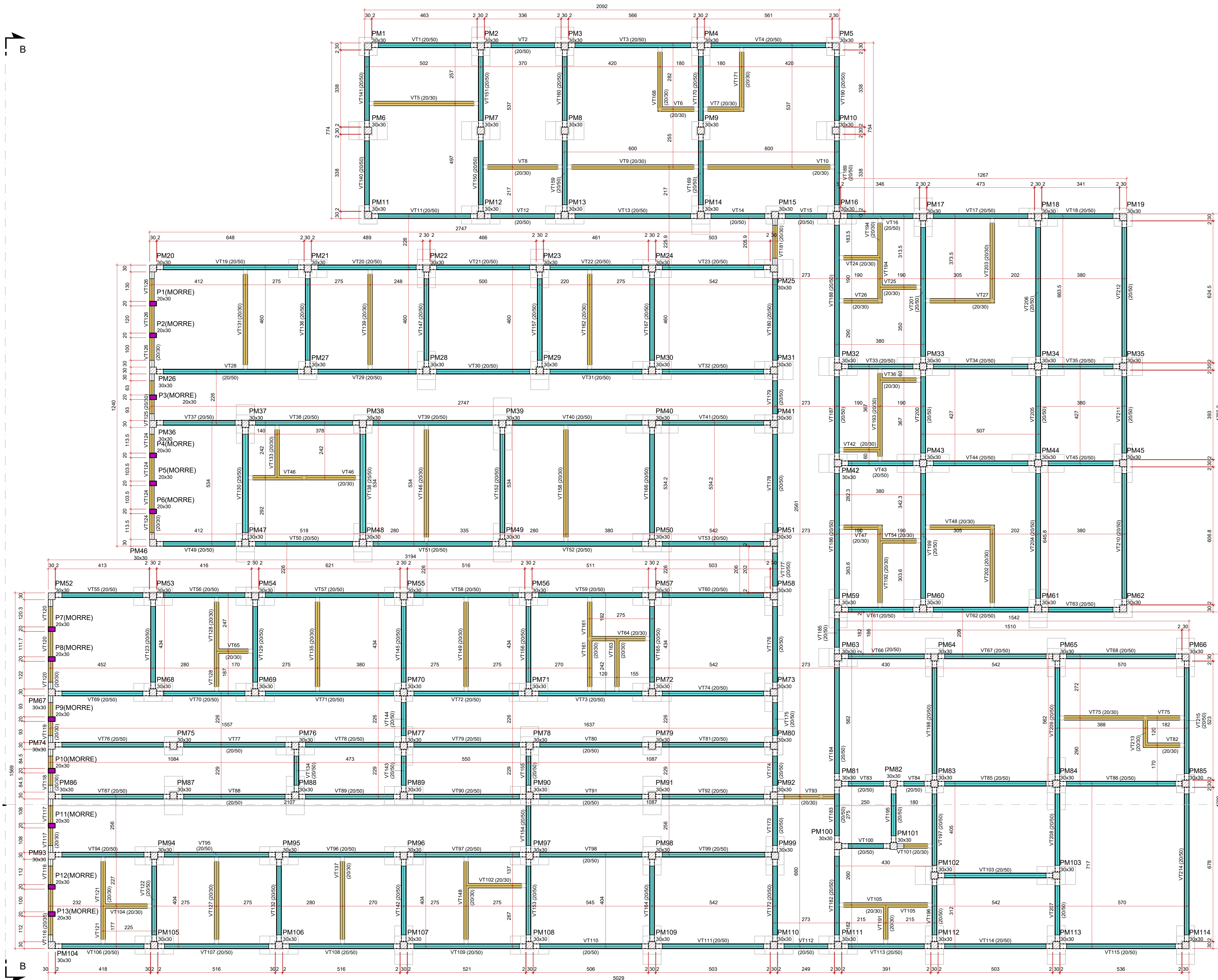
FORMA DO PAVIMENTO BALDRAME (NÍVEL 0) ESCALA 1:75
