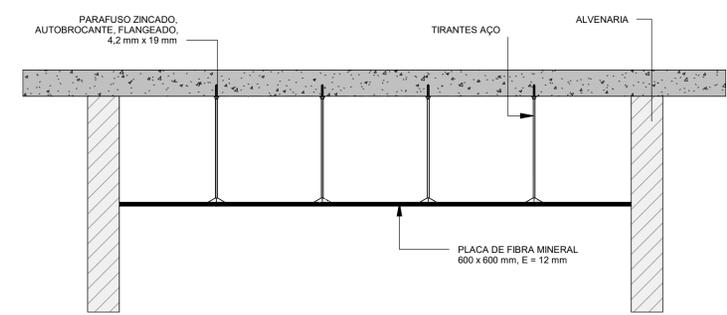
**2** DETALHE DE FIXAÇÃO DE FORRO MINERAL 1
