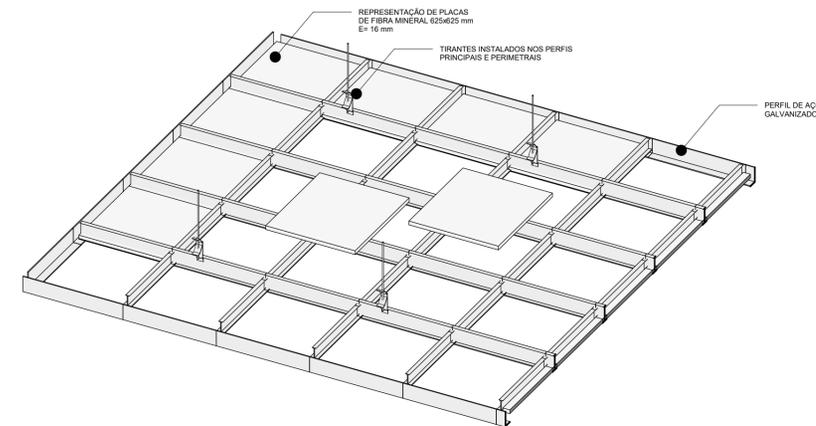
**3** DETALHE DE FIXAÇÃO DE FORRO MINERAL 02
