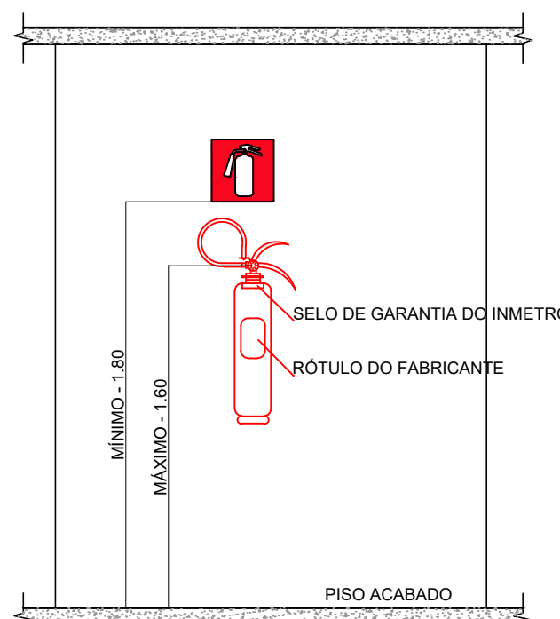
DETALHE DE INSTALAÇÃO DO EXTINTOR
