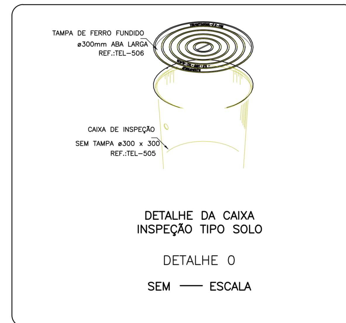
CAIXA DE INSPEÇÃO SEM ESCALA
