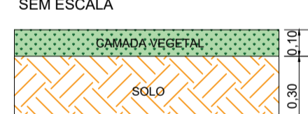
PERFIL DE DEMOLIÇÃO - TIPO 6 SEM ESCALA
