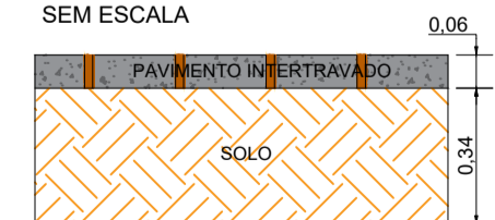
PERFIL DE DEMOLIÇÃO - TIPO 4 SEM ESCALA
