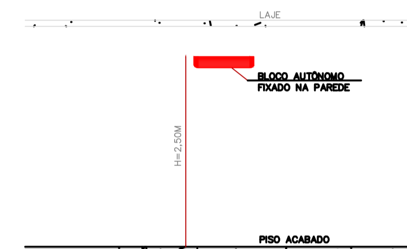
DETALHE DE ILUMINAÇÃO DE EMERGÊNCIA CONFORME NBR 10.898/99 SEM ESCALA
