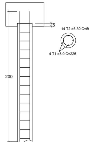
DETALHE DA ESTACA Ø20
