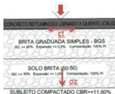
**Figura 1 – Demonstração dos Carregamentos num Pavimento Flexível.**
