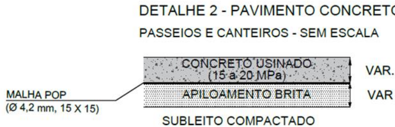
Figura 12 - Pavimento Concreto Usinado Calçada de 5 cm.
