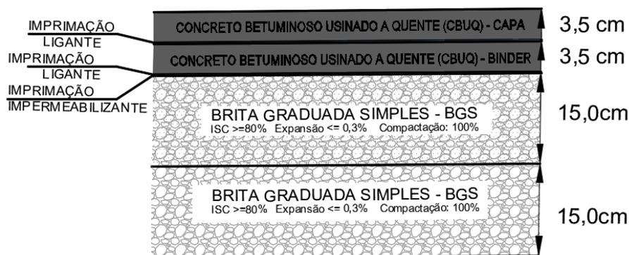
Figura 7 – Detalhamento do pavimento flexível
