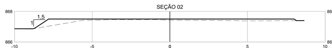
**DETALHE DOS TALUDES DE ATERRO**
