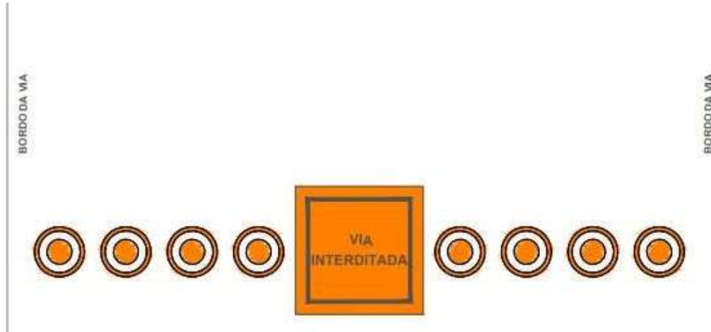
Figura 5-4 - Sinalização temporária para interdição da rua Fonte: DAC Engenharia, 2022.
