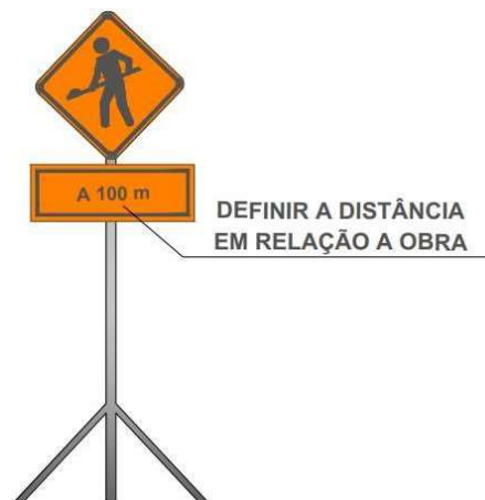
Figura 5-5 – Complementação da sinalização temporária Fonte: DAC Engenharia, 2022.
