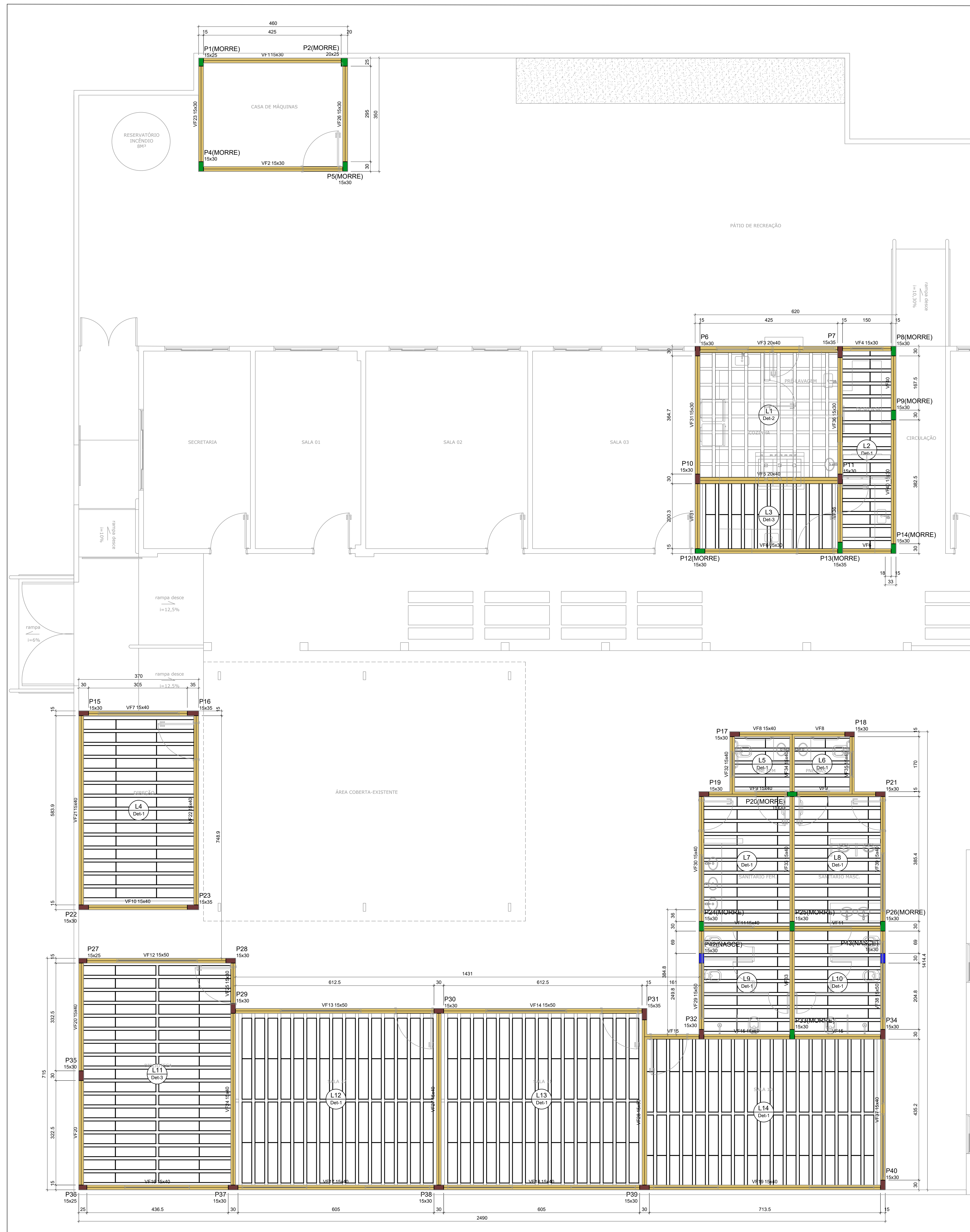
Forma do nível Forro (3,60) escala 1:50
