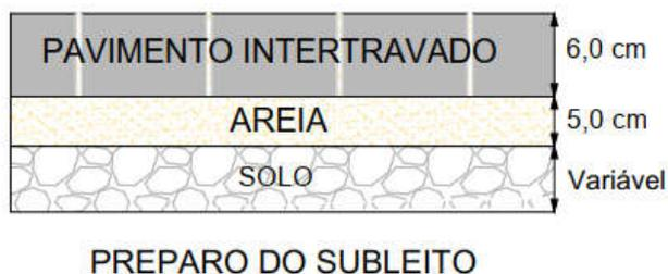
**Figura 14-2 - Detalhe dos intertravados no passeio**
