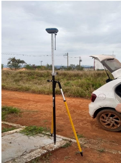
Figura 2.1 – Sistema de Levantamento Topográfico por GPS
