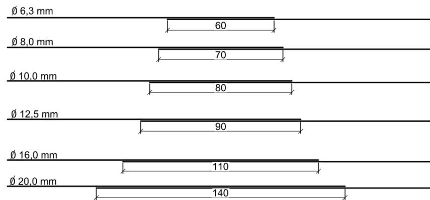
OBS: COLOCAR AS EMENDAS EM PONTOS ALTERNADOS
