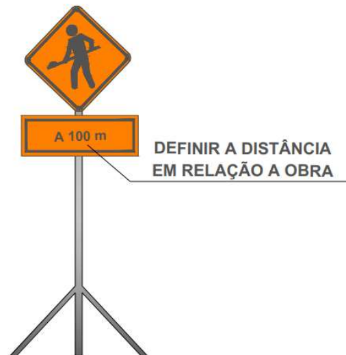
Figura 8-4 - complementação da sinalização temporária de obra
