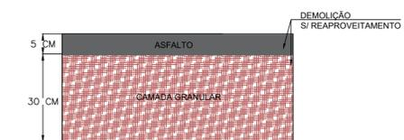
**CAMADA DE RECOMPOSIÇÃO DO PAVIMENTO ASFÁLTICO SEM ESCALA**
