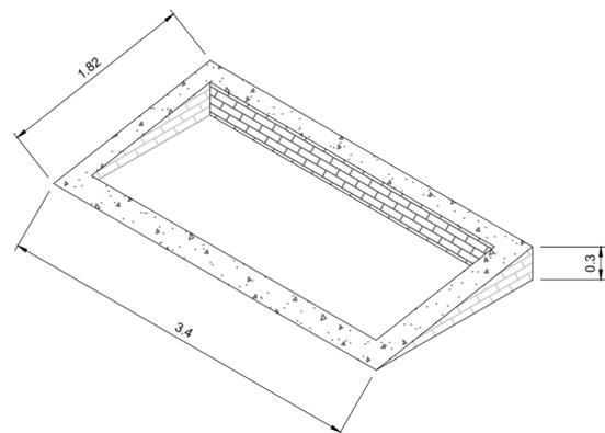
DEVERÁ SER FEITO UMA ALVENARIA DE 30CM DE ALTURA PARA QUE HAJA INCLINAÇÃO
