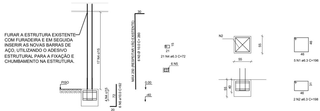
FURAR A ESTRUTURA EXISTENTE COM FURADEIRA E EM SEGUIDA INSERIR AS NOVAS BARRAS DE AÇO, UTILIZANDO O ADESIVO ESTRUTURAL PARA A FIXAÇÃO E CHUMBAMENTO NA ESTRUTURA.
