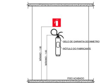
DETALHE DE INSTALAÇÃO DO EXTINTOR
