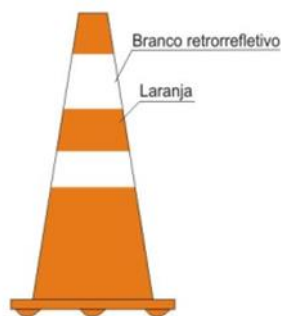
Figura 8-1 - Dispositivo de canalização
