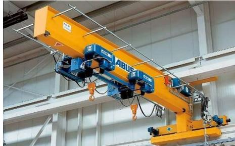
Figura 2 – Ponte rolante com talha elétrica
