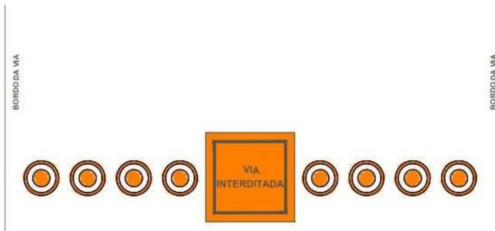
Figura 5-3 - Sinalização temporária para interdição da rua
