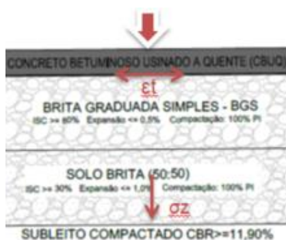
Figura 2 – Demonstração dos Carregamentos num Pavimento Flexível.
