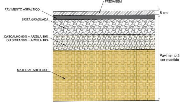
DETALHE 3 - REMOÇÃO DE CAMADA VEGETAL TIPO 01 SEM ESCALA
