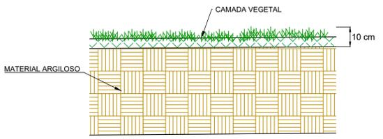
DETALHE 4 - REMOÇÃO DE CAMADA VEGETAL TIPO 02 SEM ESCALA
