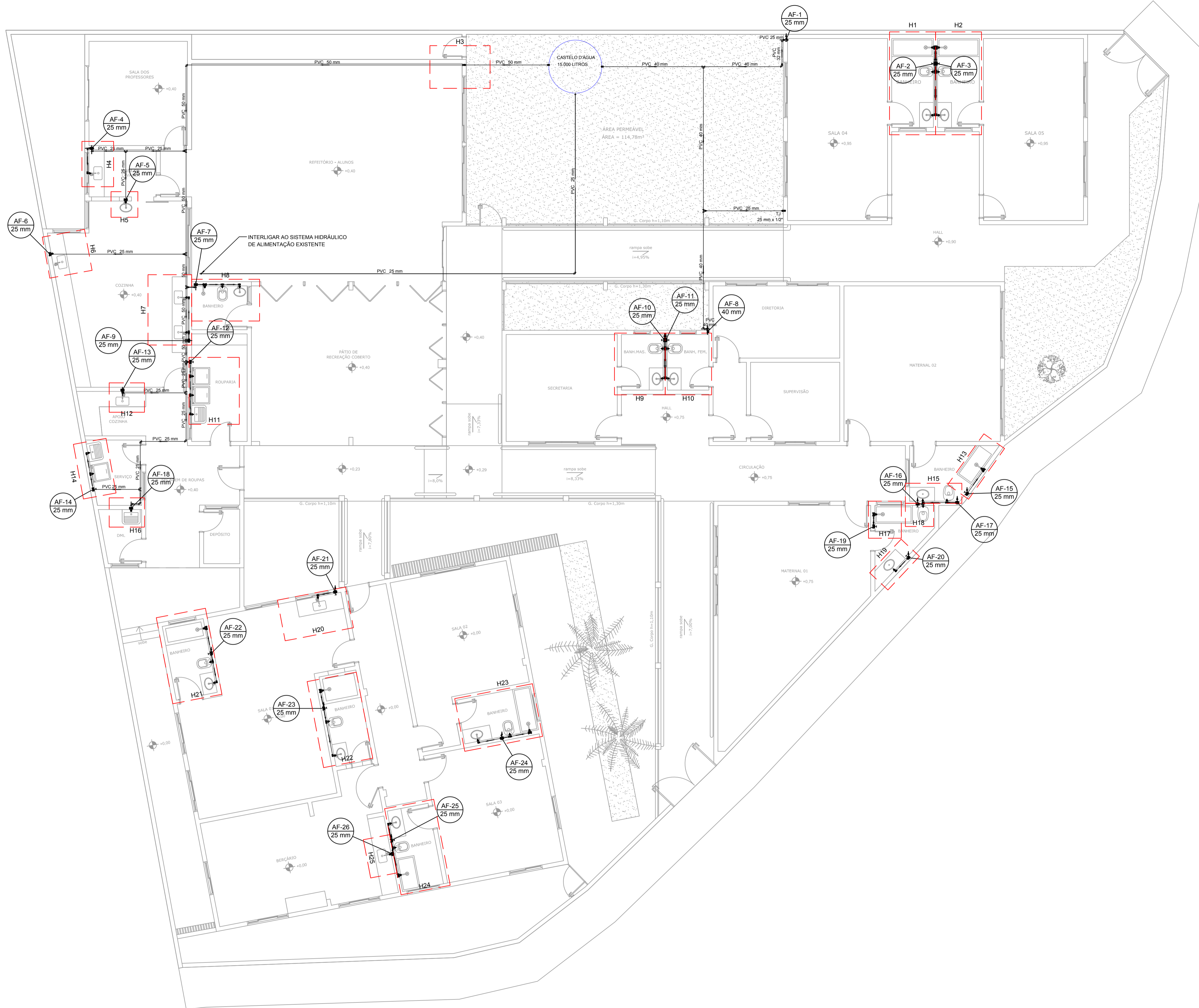
PLANTA BAIXA INSTALAÇÕES HIDRÁULICAS TÉRREO ESCALA 1:75
