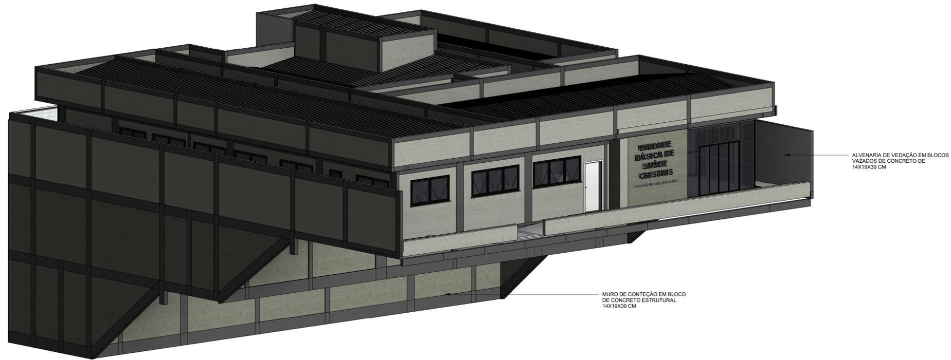
**1** DET. ALVENARIA - VISTA FRONTAL E LATERAL ESQUERDA
