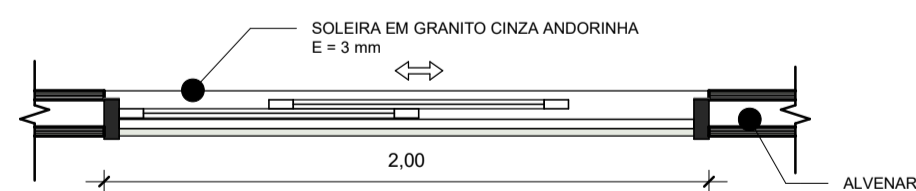
PV1 Dimensões: 2,00 x 2,10 cm Descrição: PORTA DESLIZANTE 2 FOLHAS
