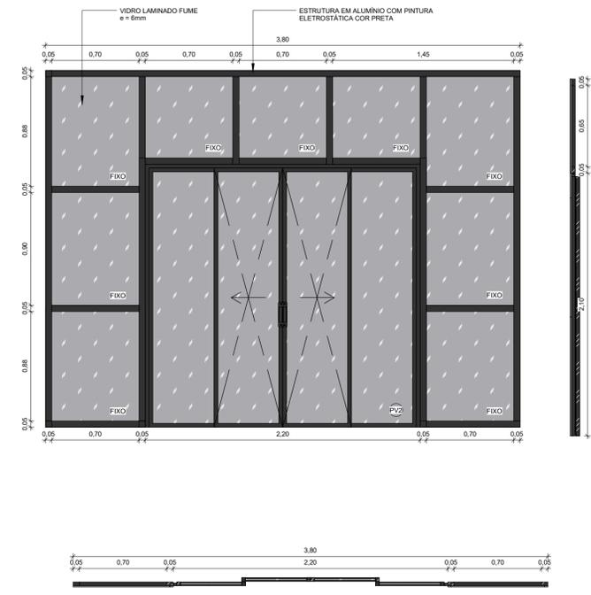
**PL2** ESQUADRIA DE ALUMÍNIO E VIDRO TIPO PELE DE VIDRO, COM PORTA DE VIDRO - COM PINTURA ELETROSTÁTICA COR PRETA E VIDRO LAMINADO FUME ESP. 6mm. DIM. 2,85 X 3,80 m
