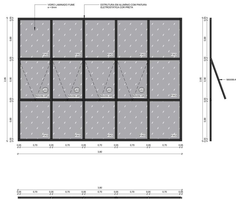
**PL1** ESQUADRIA DE ALUMÍNIO E VIDRO TIPO PELE DE VIDRO - 4 FOLHAS MAXIM-AR, COM PINTURA ELETROSTÁTICA COR PRETA E VIDRO LAMINADO FUME ESP. 6mm. DIM. 2,85 X 3,80m
