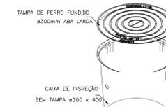
DETALHE - CAIXA DE INSPEÇÃO TIPO SOLO SEM ESCALA
