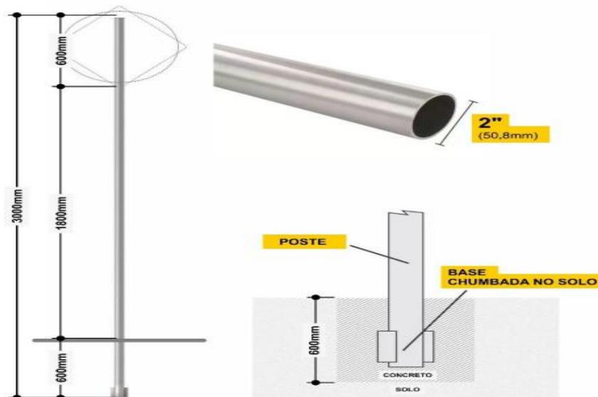
*Imagem 1. Detalhes Postes Metálicos e Chumbamento. Fonte. CONTRAN, 2007.*
