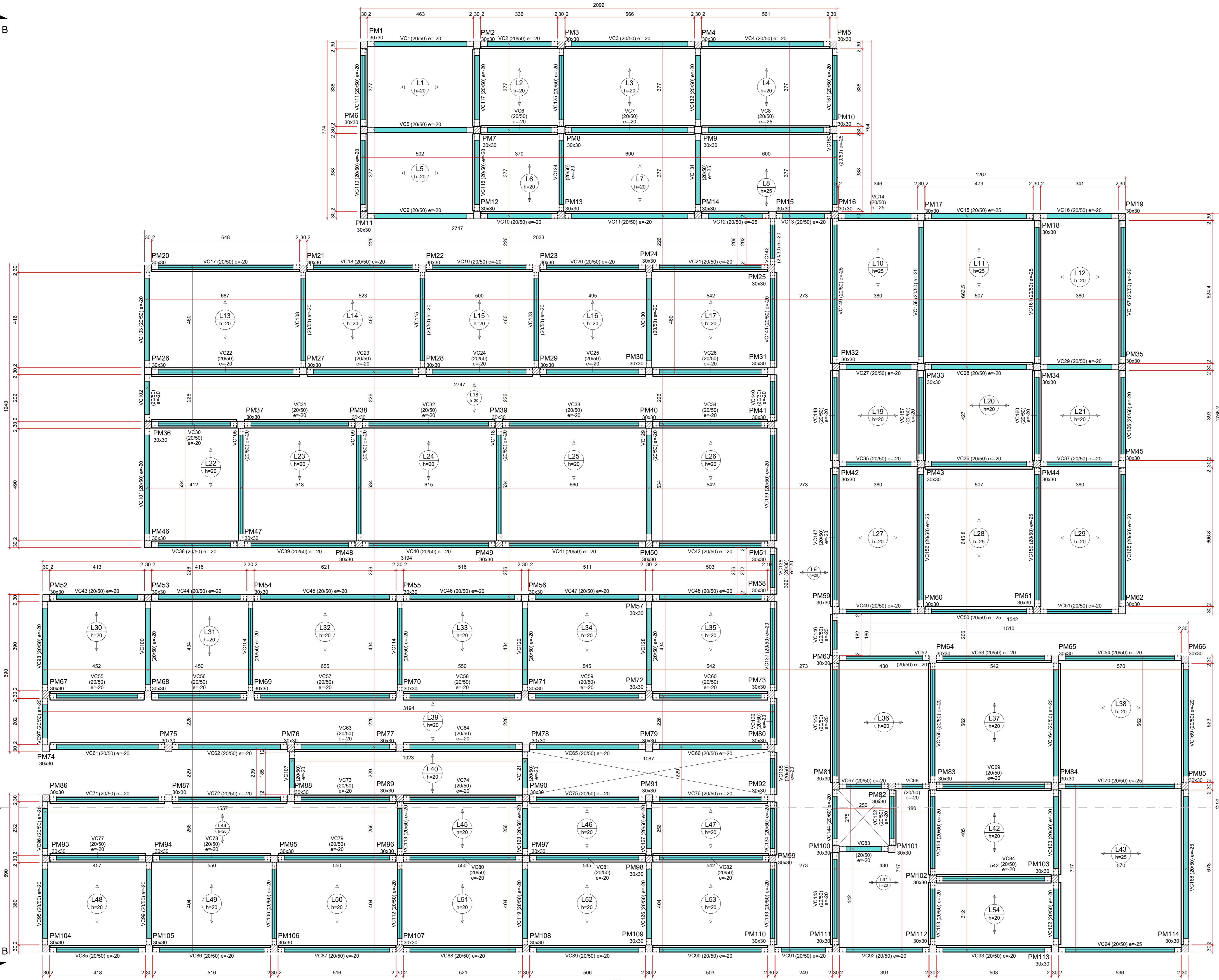
FORMA DO PAVIMENTO COBERTURA (NÍVEL 400) ESCALA 1:75
