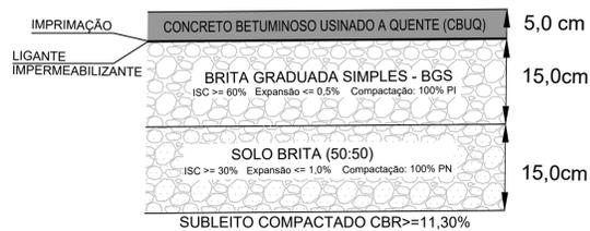
**DETALHE 2 - PAVIMENTO CONCRETO USINADO**
