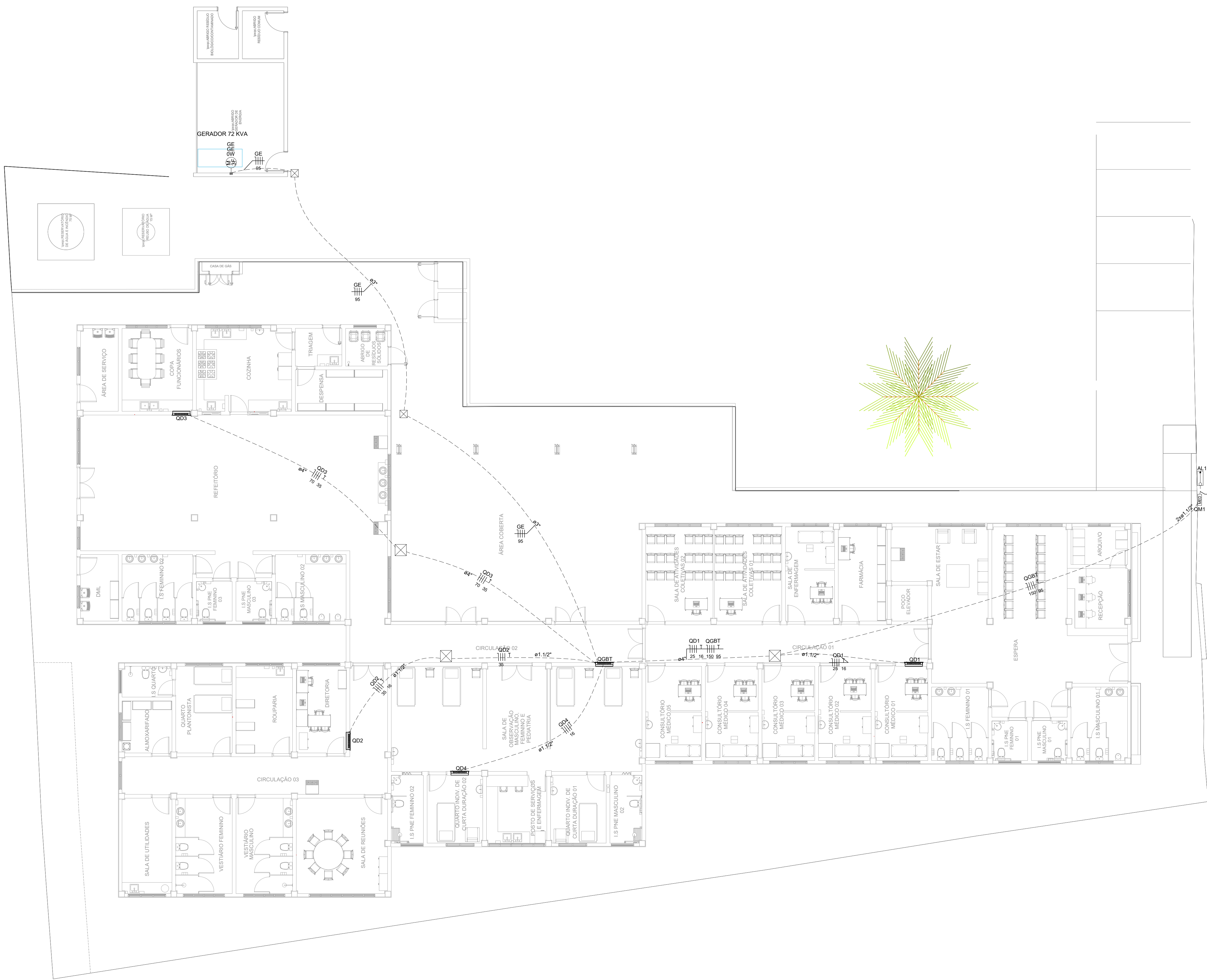
PLANTA BAIXA – QUADROS DE DISTRIBUIÇÃO ESCALA 1:100
