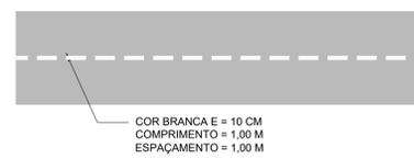
**LINHA SIMPLES SECCIONADA LMS-2 SEM ESCALA**
