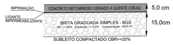
DETALHE 2 - PAVIMENTO CONCRETO USINADO CALÇADAS - SEM ESCALA
