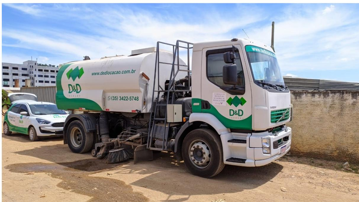
Figura 34 - Caminhão de varrição automática utilizado na limpeza de vias movimentadas
