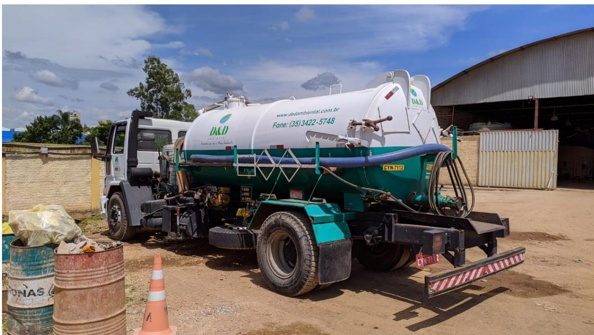
Figura 43 - Caminhão de limpeza de boca de lobo
